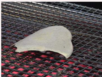
加熱して水銀を飛ばすことで、水銀が蒸発し金具表面に鍍金され、銀色だった銚金具が金色に変化します。
